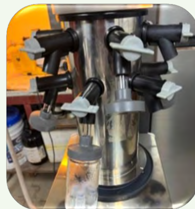
Liofilización de aislados de hongos entomopatógenos en viales de 5 mL para su conservación a largo plazo.
