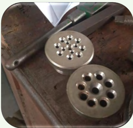
Trefiladora de 3 mm al lado de la de 5 mm que se usará para hacer “pellets” para alevines de tilapia.
