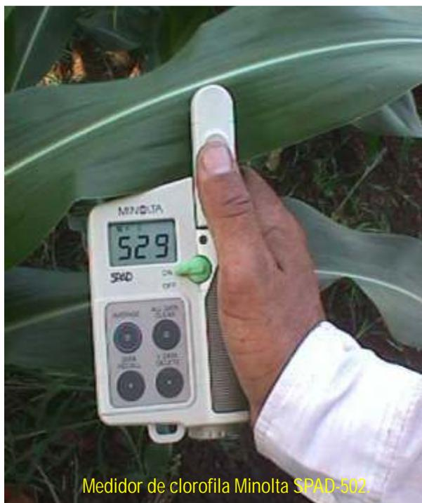
Medidor de clorofila Minolta SPAD-502.
