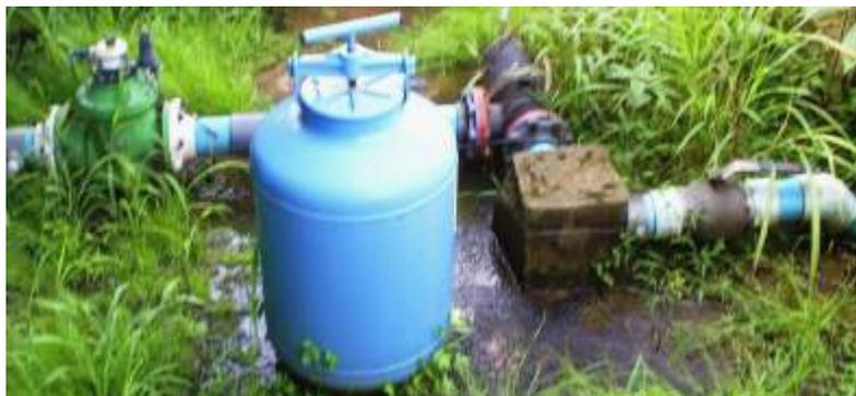
Figura 8. Parte del equipo empleado en fertirriego, tanque dosificador y tubería de transporte.
