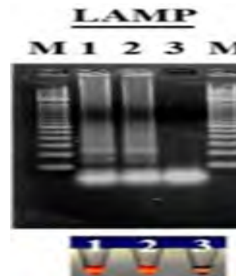
Detección de begomovirus mediante la técnica LAMP.
