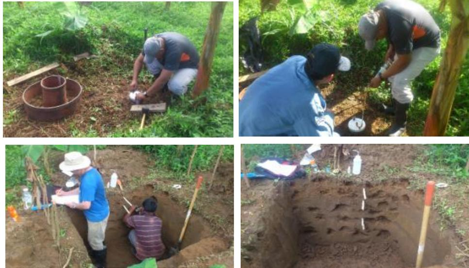
Figura 7. Excavación de calicatas y toma de muestras de suelos en parcelas de producción de plátano en Bocas del Toro.
