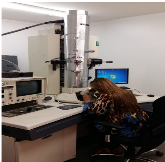
Figura 17. Microscopio Electrónico de Transmisión ubicado en el Centro de Investigación en Estructuras Microscópicas (CIEMIC), Universidad de Costa Rica.
